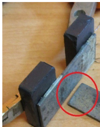
Campo Magnético Anulado en el hierro de Puente no atrae al hierro sin magnetizar
